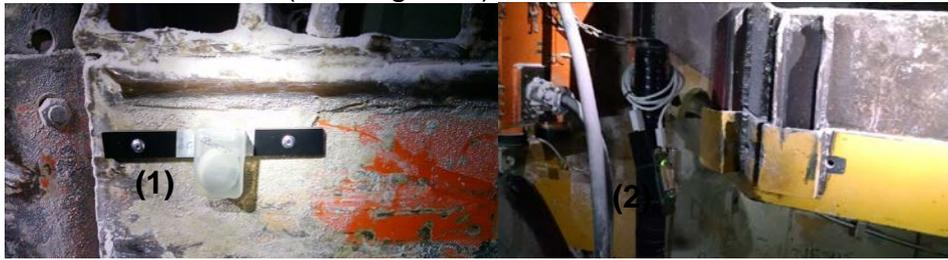
**Figura 5.** Beacon BLE fixado na lateral do Shuttle Car (1) e Microcomputador próximo ao feeder (2).
