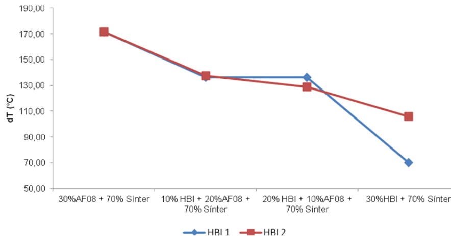
Figura 6. Efeito do HBI na espessura da zona coesiva, representada por \Delta T .
