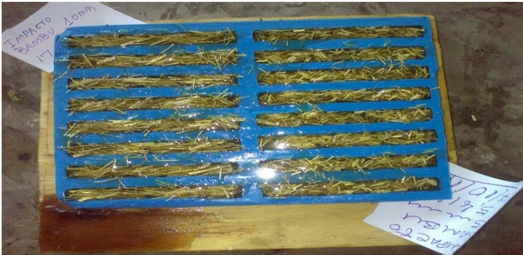
**Figura 9.** Molde de silicone com material depositado.
