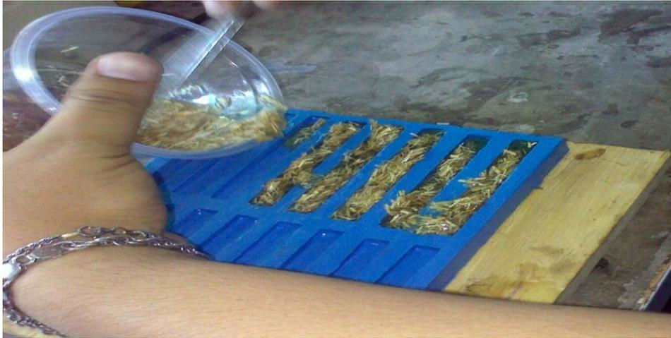
**Figura 8.** Homogeneização (fibra/resina) e vazamento no molde.
