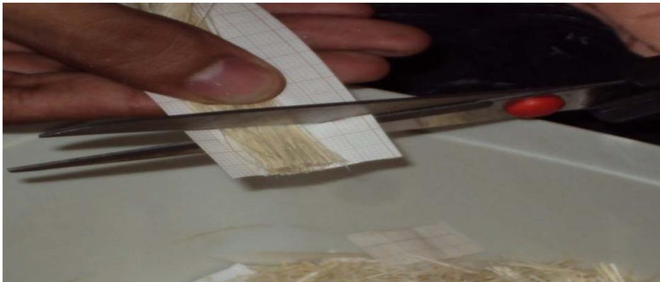
**Figura 2.** Corte manual das fibras de sisal.
