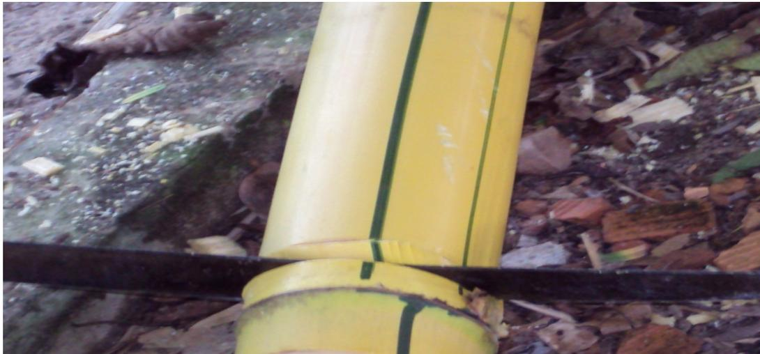
**Figura 4.** Corte da planta de bambu em colmos.
