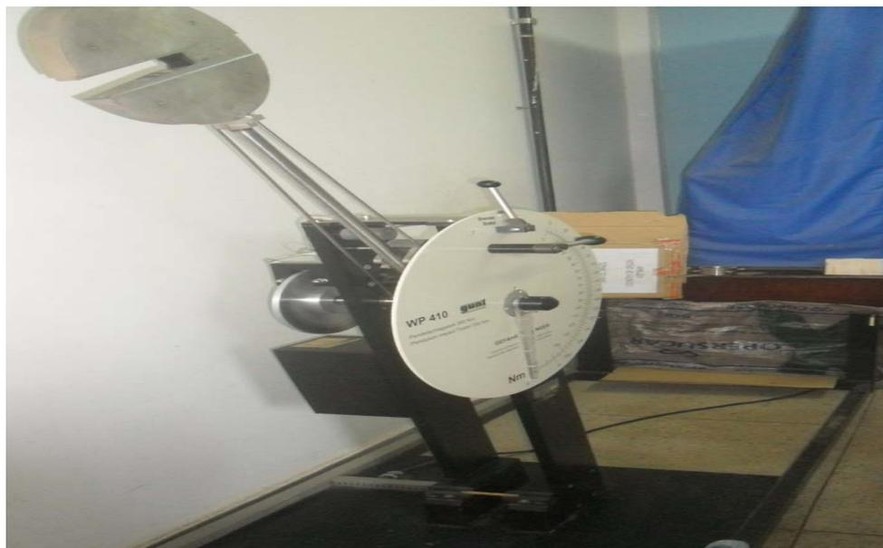
**Figura 15.** Máquina de ensaio modelo WP 410 da Gunt Hamburg.
