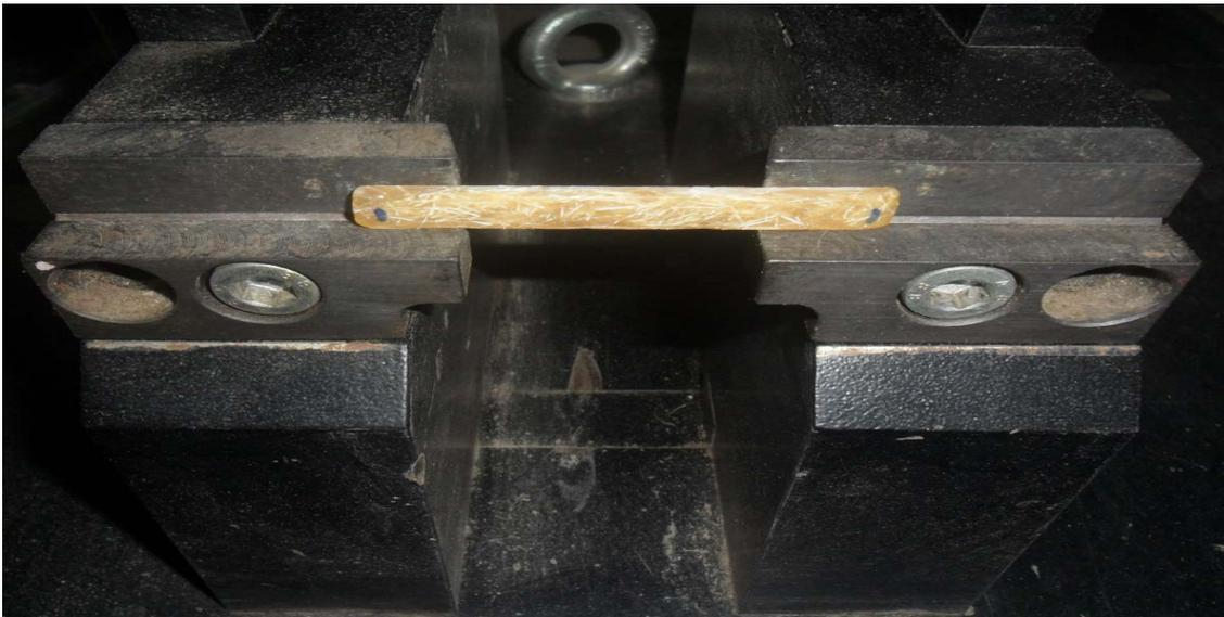
**Figura 14.** Corpo de prova no porta amostra da máquina de ensaio Charpy.
