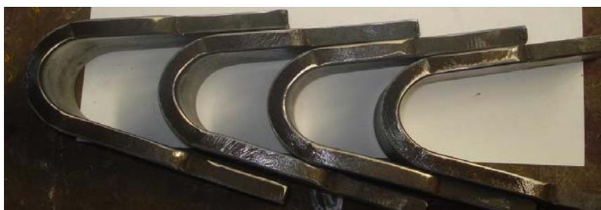
**Figura 3.** Aspecto dos corpos-de-prova de dobramento após o ensaio.
