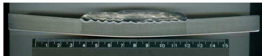
**Figura 2.** Macrografia referente à amostra soldada por eletrodo revestido.
