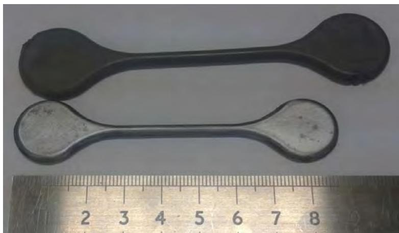
Figura 3. Peça verde e peça sinterizada de ABNT 8620.
