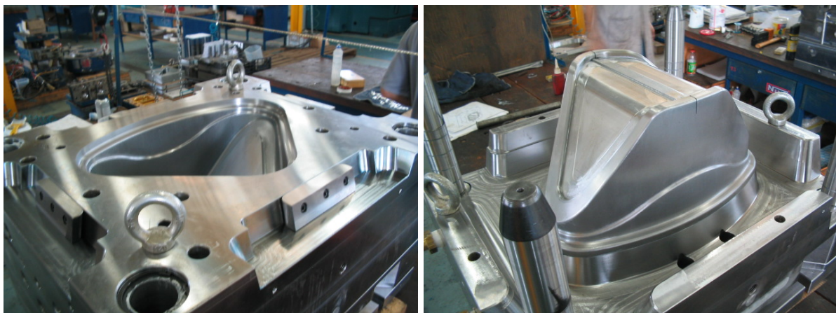
Figura 6: Algumas fotos de um molde produzido em VP100. Dimensões do molde: aproximadamente 700 mm x 700 mm x 400 mm.
