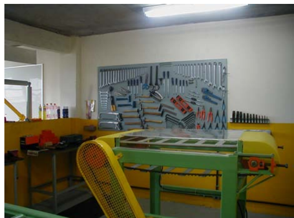
Figura 6. Esteira transportadora e quadro de chaves ao fundo
