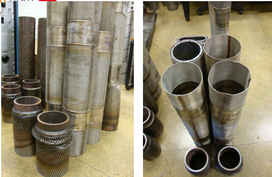
Figura 7. Visão dos elementos filtrantes após testes em grande escala.
