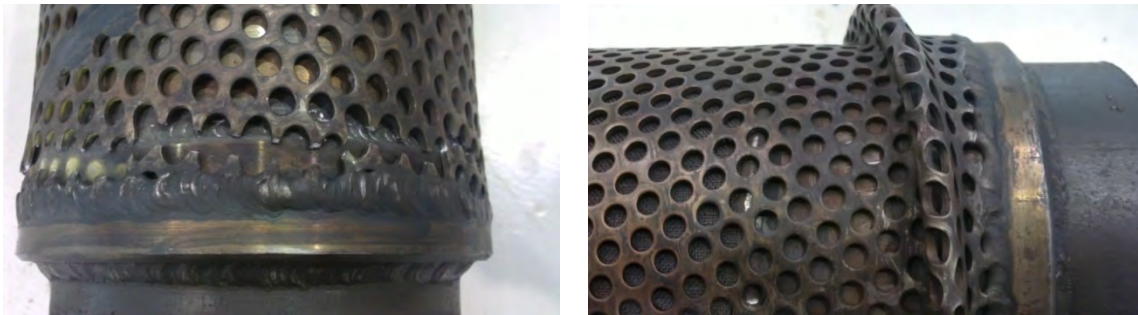
Figura 8. Tela Premium após ensaio de arrancamento, evidenciando ruptura na ZTA.
