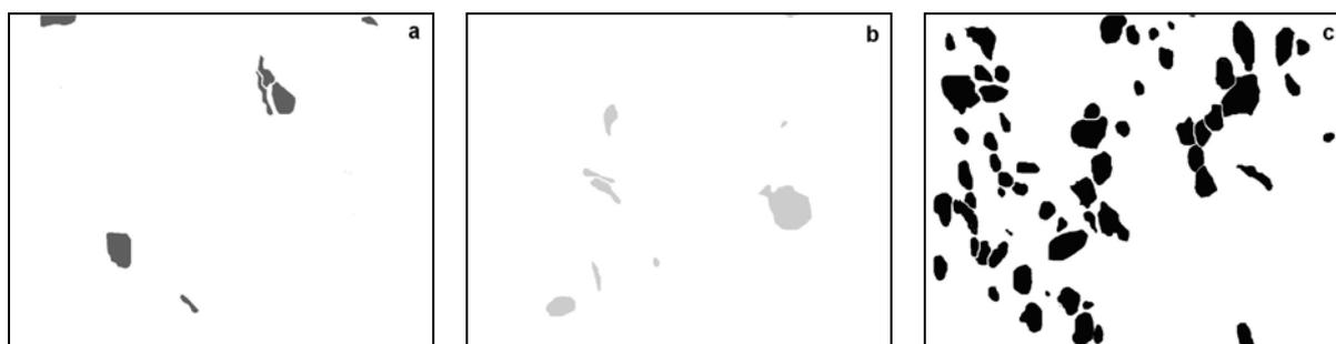
**Figura 9.** Separação de precipitados da amostra B.  $M_{23}C_6$  (a),  $M_6C$  (b) e  $M_7C_3$  (c).
