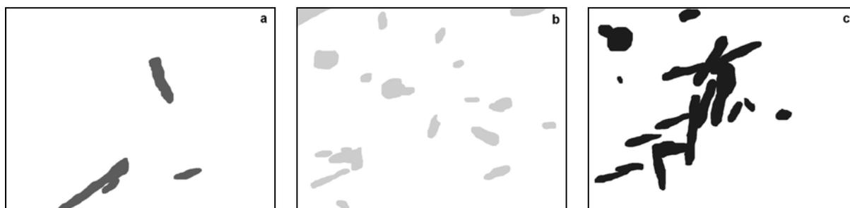
**Figura 8.** Separação de precipitados da amostra A.  $M_{23}C_6$  (a),  $M_6C$  (b) e  $M_7C_3$  (c).
