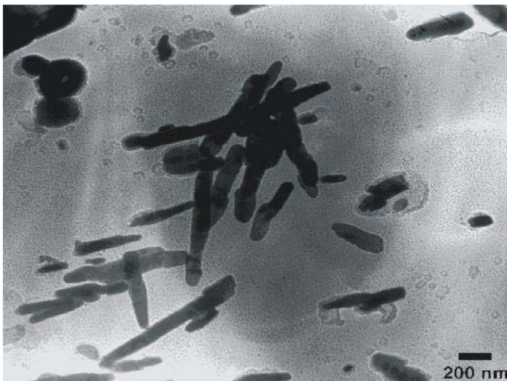
**Figura 3.** Carbonetos observados na amostra A.
