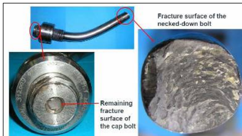
Figura 12. Parafuso de fixação do cone. (4)
