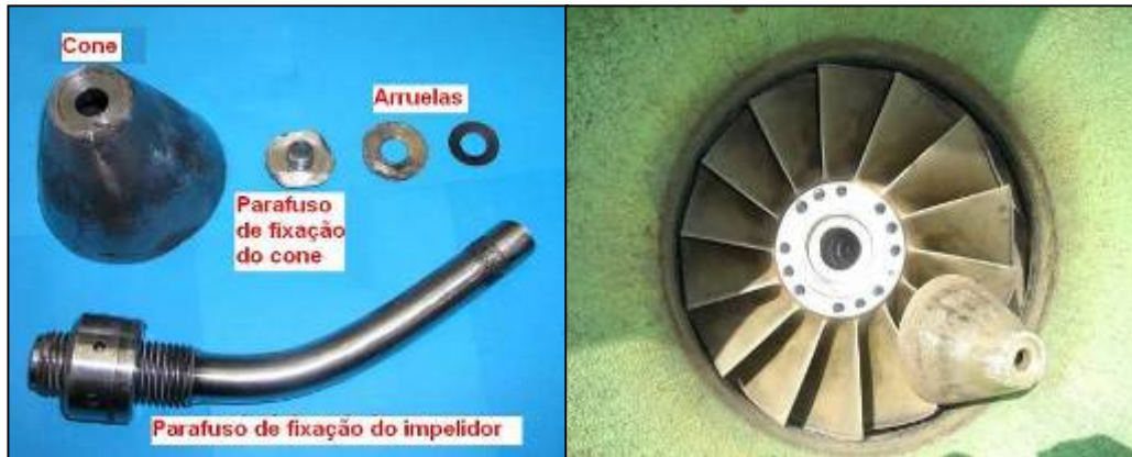
Figura 5. Foto das peças de fixação do impelidor e impelidor após o acidente. (1)
