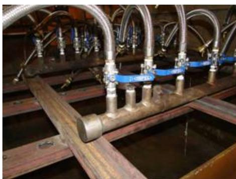
Figura 13: Sistema de limpeza dos bicos sprays.
