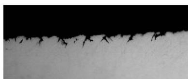
Superfície externa da região submetida a 12 horas em ácido, foram identificadas corrosões de 3 a 9  $\mu\text{m}$  de profundidade.
