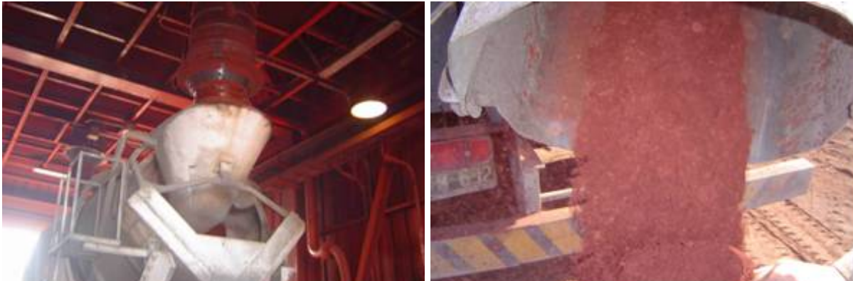
Figura 1. (a) Carga de polvo en tambor giratorio; y (b) descarga de material aglomerado.
