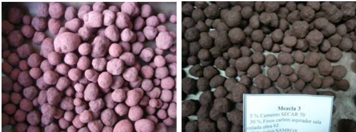
Figura 3. (a) Pellets verdes de polvo de decapado con 15%de reductor; y (b) 30% de reductor.
