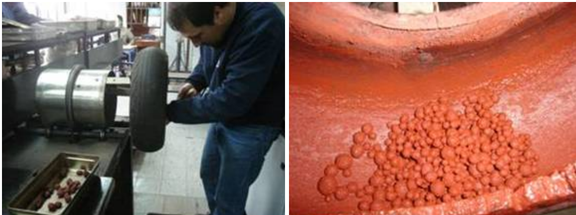
Figura 2. (a) Dispositivo giratorio; y (b) pellets formados.
