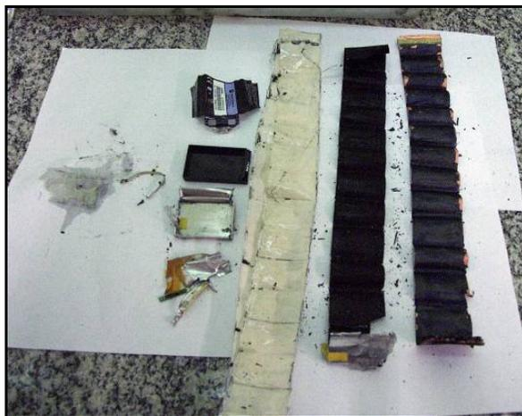
**Figura 2** - Componentes de uma bateria desmontada
