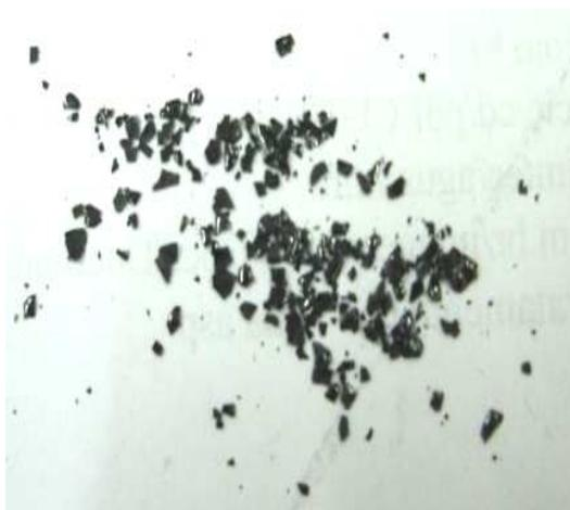
**Figura 3** - Foto do DME produzido nas condições  $j = 1,69\text{A.dm}^{-2}$  e  $T = 98^\circ\text{C}$  após removido da superfície do eletrodo.
