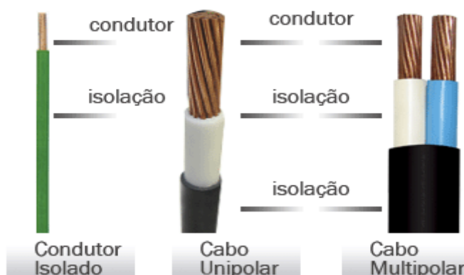
Figura 2: Tipos de cabos elétricos
