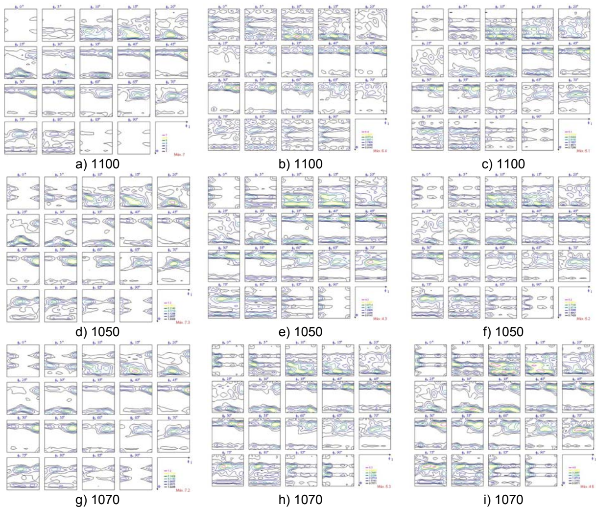
Figura 6 – FDO dos alumínios laminados a 70% sem tratamento térmico (a, d e g), tratados termicamente a 350°C/1 h (b, e e h) e a 500°C/1 h (c, f e i), polidos eletroliticamente e sem ataque.
