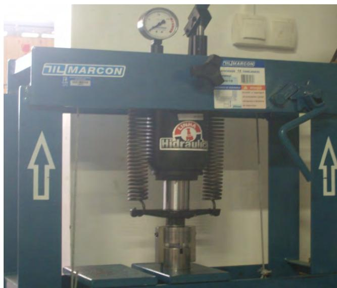
**Figura 2.** Prensa hidráulica Marcon, modelo MPH-15 com capacidade de carga de 15 toneladas e matriz utilizadas na deformação.
