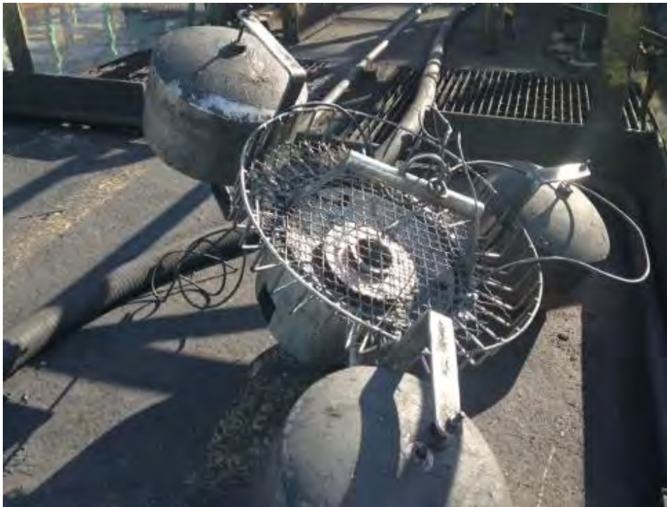
Figura 5. Redução da malha dos Skimmers flutuantes.
