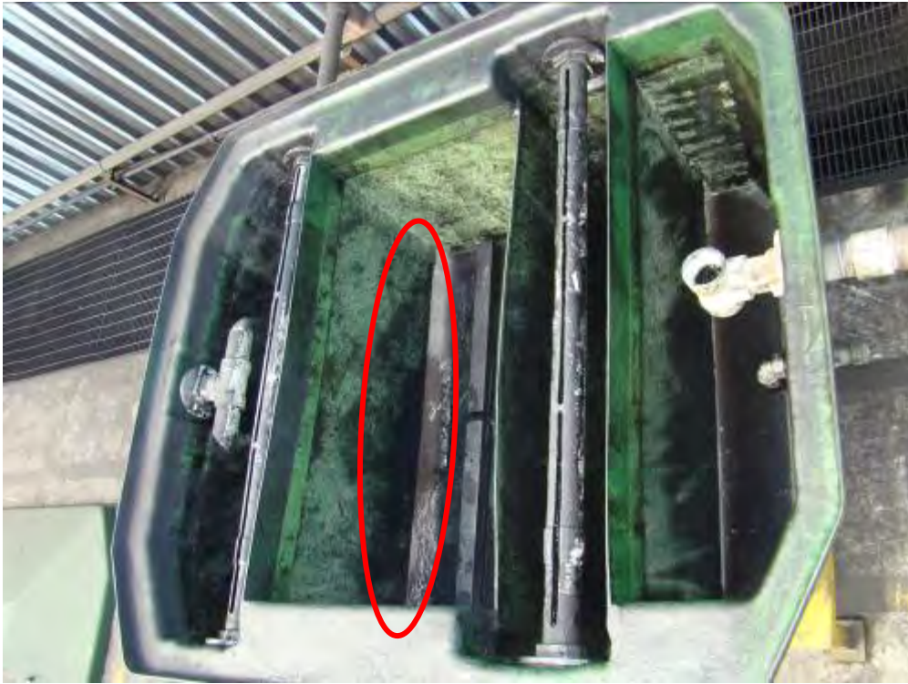
Figura 3. Aumento dos vãos de comunicação do tanque Alpina.
