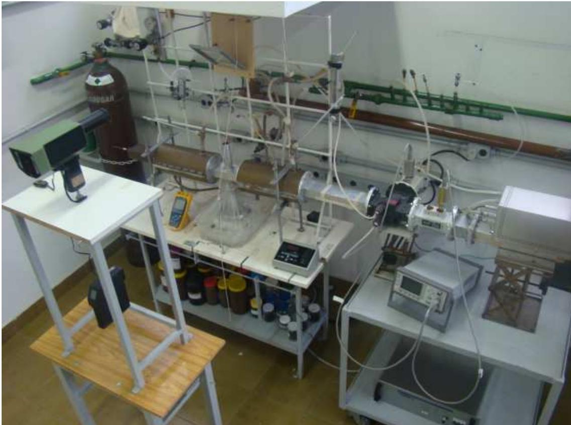
**Figura 1** - Forno para redução de minério de ferro por irradiação de micro-ondas.
