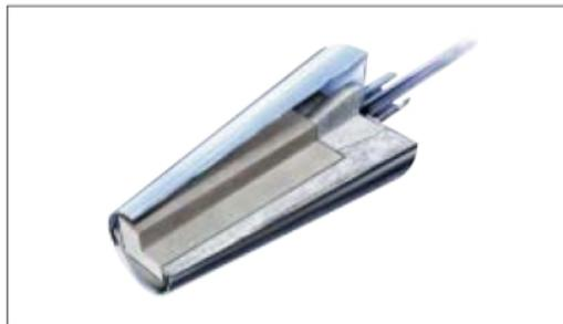
**Figura 3:** Corte transversal Plug híbrido
