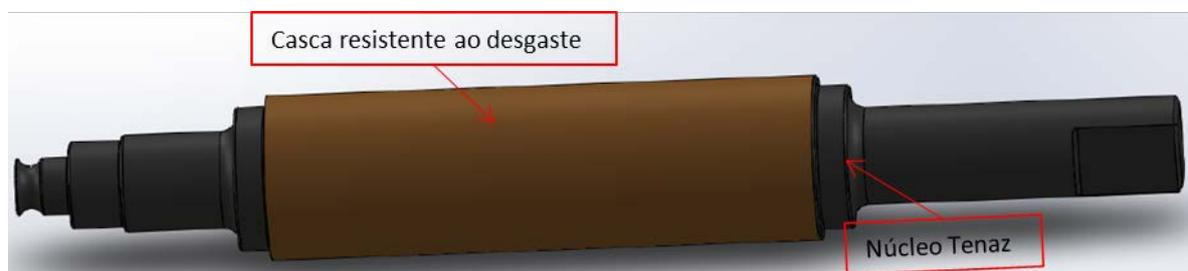
**Figura 3.** Cilindro de laminação
