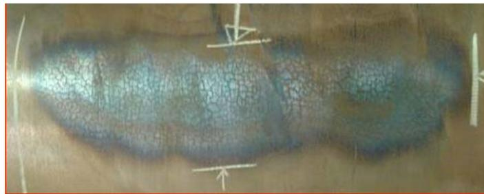
**Figura 15.** Trincas térmicas na superfície dos cilindros de trabalho devido contato prolongado com a tira quente, em função de parada do material no gap dos cilindros (sucata).
