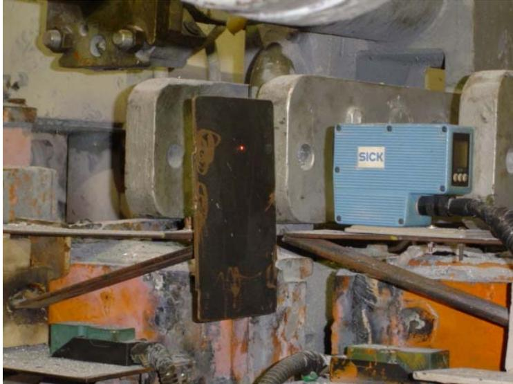
Figura 12: Sistema de medição de distância a laser para as navalhas de
