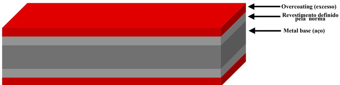
Figura 4 – Representação esquemática do *overcoating* na tira zincada
