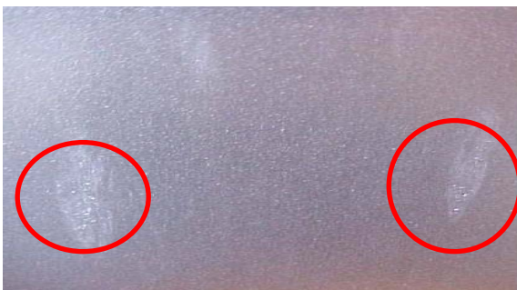
Figura 1 - Marca Deslizamento A
