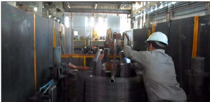
**Figura 2 :** Risco de acidente pessoal durante a preparação do rolo, pois o operador fica exposto a operação do outro desbobinador. Votorantim Siderurgia – Unidade Resende, RJ.
