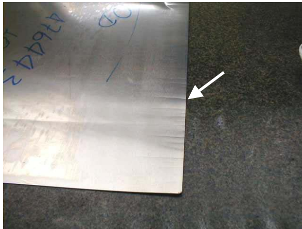
Figura 1. Defeito Quebra de Desbobinamento - QD
