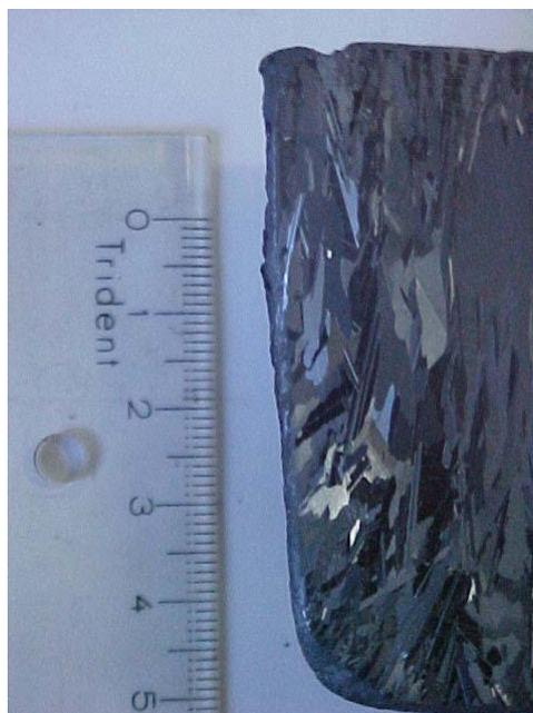
**Figura 4** – Detalhe da macrografia da secção longitudinal na região próxima à parede lateral.
