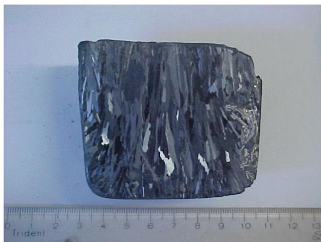
**Figura 2** – Macrografia da secção longitudinal do lingote obtido.
