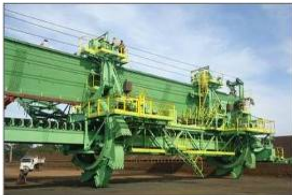
Figura 13. Imagem do BR ( Blending Reclaimer ), após a reforma. (1)
