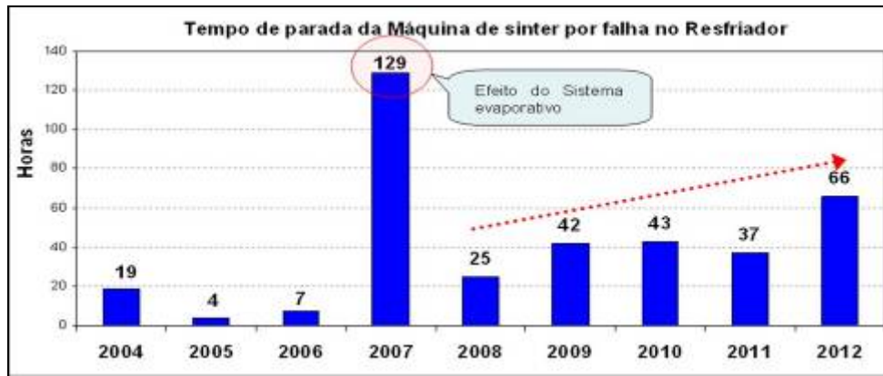
Figura 8. Histórico de falhas do Resfriador.
