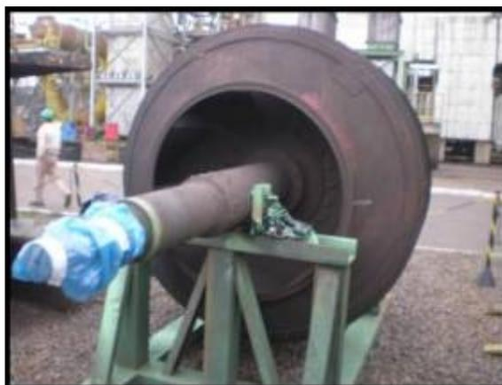
**Figura 9.** Substituição do rotor de ventilador.
