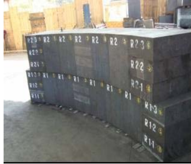
Figura 14. Blocos de carbono cortados, usinados e pré montados. (3)
