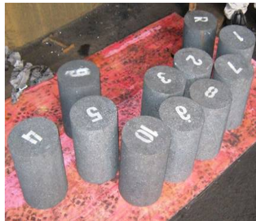
Figura 15. Cilindros de carbono para recomposição do furo da salamandra cortados, usinados e identificados. (3)
