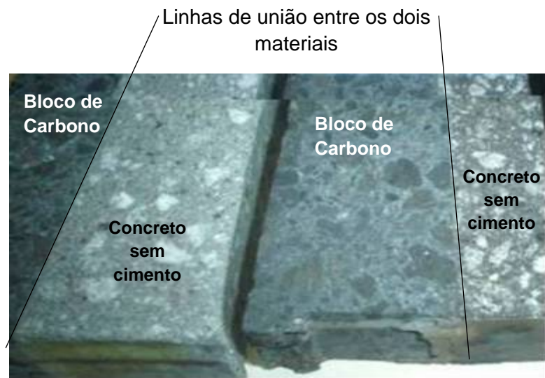
Figura 6. Resultado dos testes para verificação das condições de aderência entre o concreto sem cimento e os blocos de carbono. (3)
