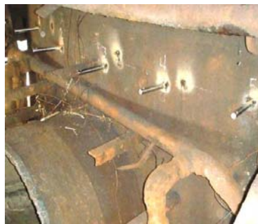
Figura 16. Travamento dos blocos de carbono com pinos de aço. (3)
