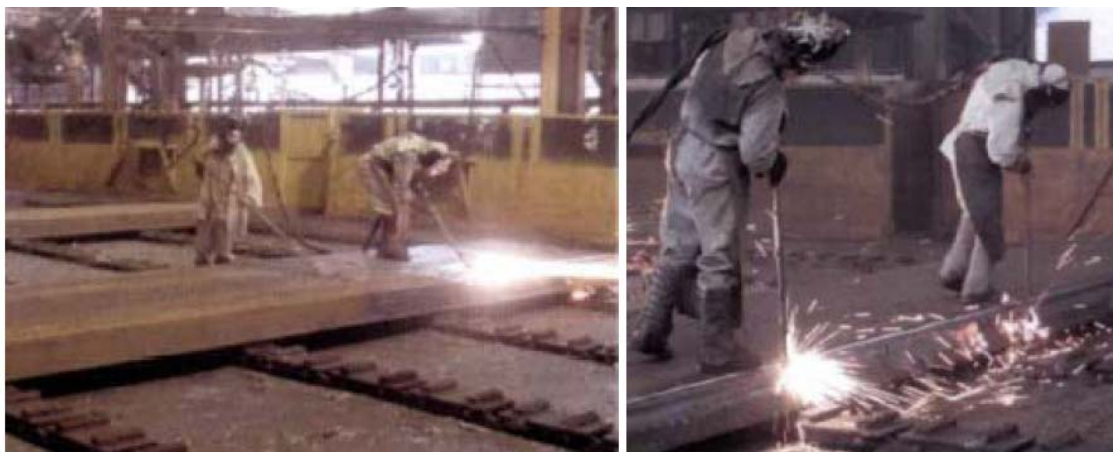
Figura 2 – Processo de escarrafagem para remoção de defeitos nas placas. (3)
