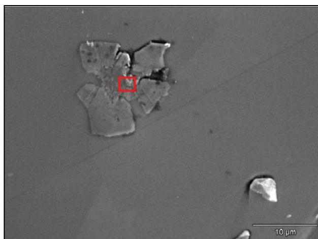
**Figura 10.** Partícula de carboneto de silício em silício. Análise por EDS realizada no ponto marcado em vermelho. Imagem de microscópio eletrônico (elétrons retroespalhados).
