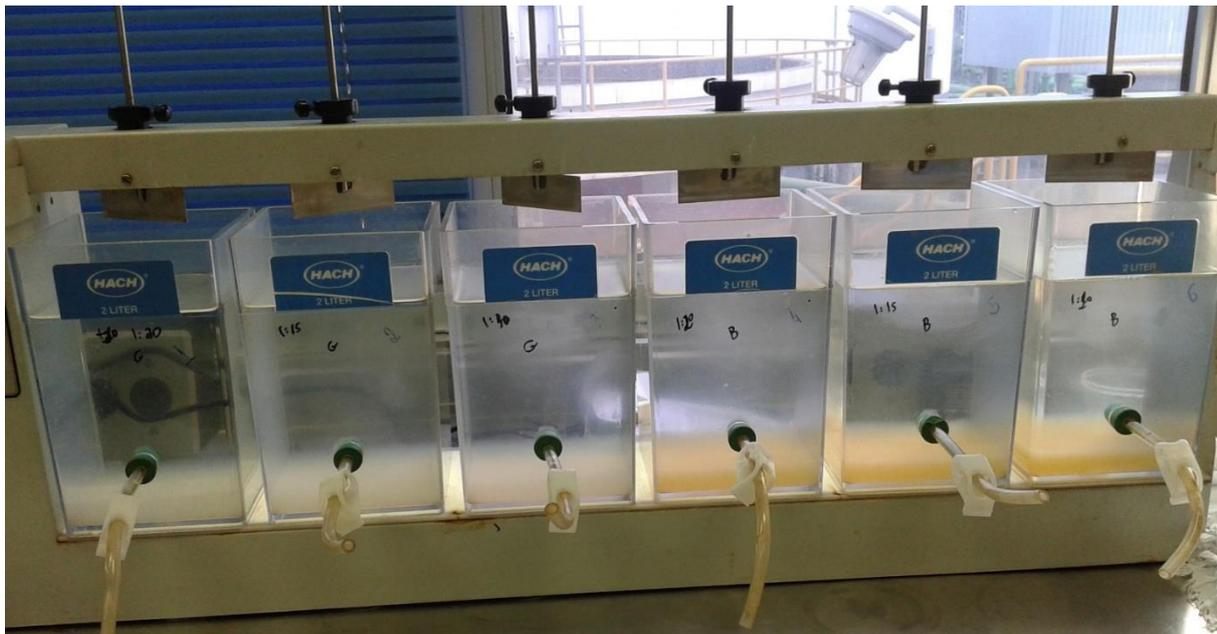
Figura 4. Equipamento de Jar Test utilizado para realização dos ensaios de remoção de fluoreto.
