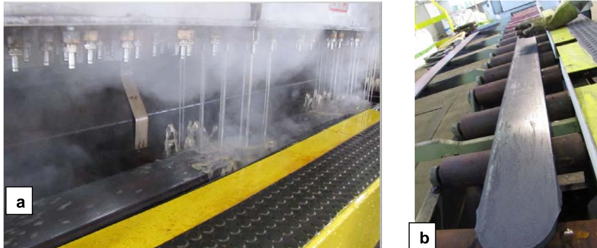
Figura 16 – (a) Placa submetida ao resfriamento alternado dos headers e (b) Placa com a planicidade inicia mantida. Mostrando a uniformidade do resfriamento nas faces superior e inferior.
