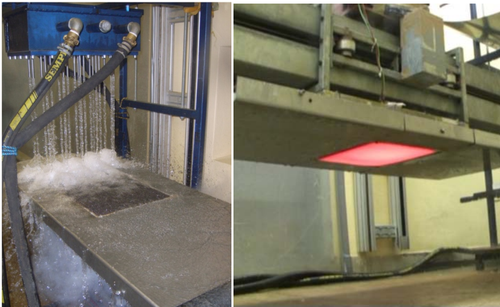
Figura 5 – Testes de performance do arranjo dos jatos, com a placa em movimento, em diferentes temperaturas de placa, velocidades de mesa, vazão de água e diâmetros dos tubos, na face superior e inferior.
