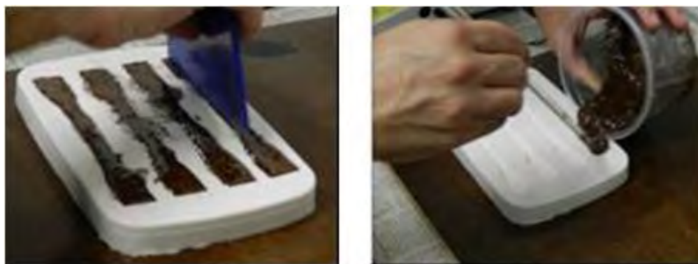
Figura 6. Envasamento da mistura no corpo de prova.
