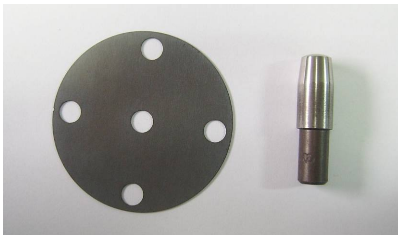
Figura 3. Geometria do pino e disco do ensaio adesivo pino-disco.
