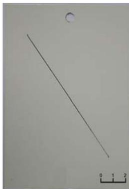
**Figura 1** – Corpo de prova com danificação mecânica intencional na película seca de tinta para teste de corrosão. Bordas e regiões de furos protegidas com tinta bicomponente epóxi poliamida.
