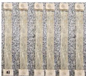
Figura 7: Corpos de prova após tração.
