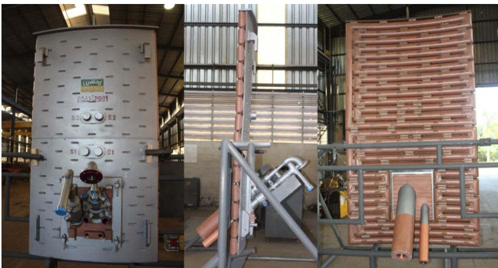
Figura 8: Pré-montagem do Conjunto Protect Block.
