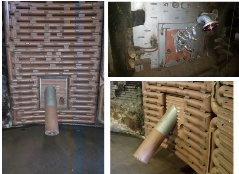
Figura 9: Montagem do Conjunto Protect Block na carcaça do forno.
