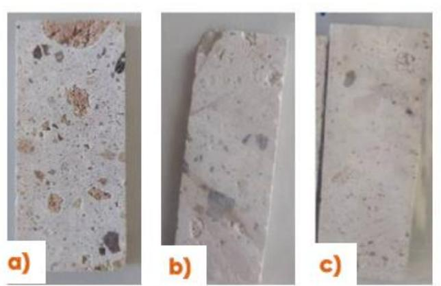
Fig. 2 Comparação da quantidade de camadas de TEOS no Sillar
