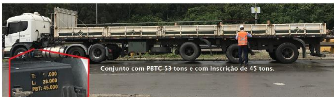
Figura 3 – Dados técnicos incompatíveis: conjunto com o PBT de 53 ton e identificado como 45 ton
