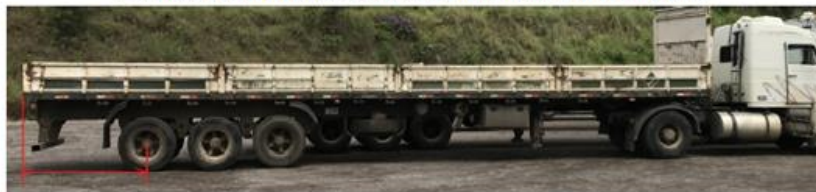
Conjunto ERRADO com trator 4x2 engatado com carreta 3 eixos fabricada para trator 6x2 (observa-se pelo balanço traseiro)
