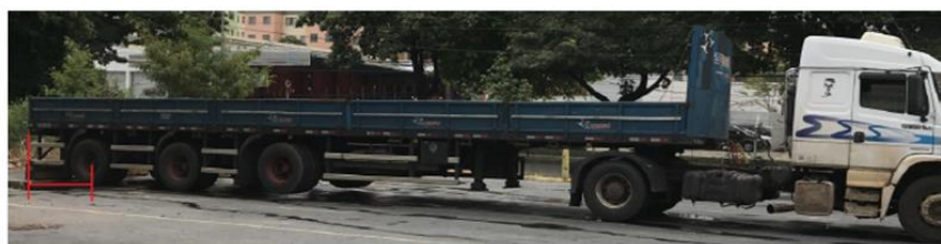
Conjunto ERRADO com trator 4x2 engatado com carreta 3 eixos distanciados fabricada para trator do tipo 6x2
