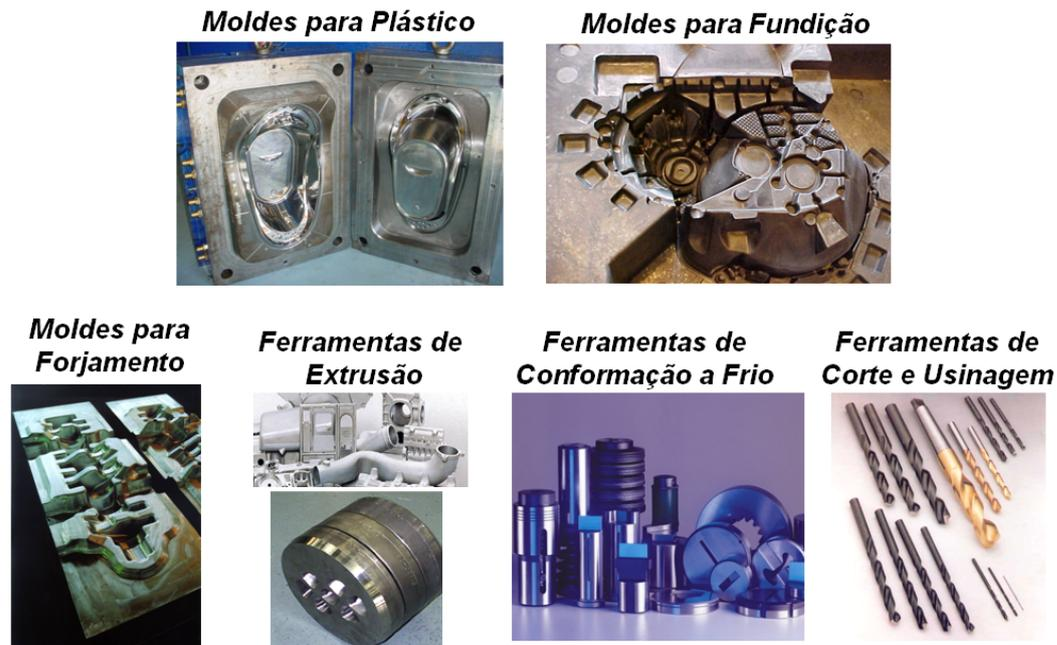
**Figura 1.** Exemplos de moldes e matrizes produzidos com aços ferramenta. Em todos os casos a têmpera e o revenimento são os tratamentos térmicos utilizados para o endurecimento.<sup>(2)</sup>
