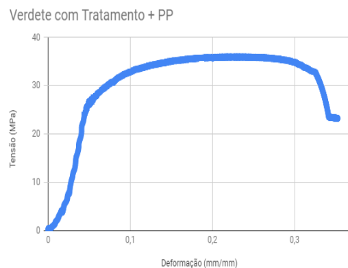
Figura 2. Curva de tensão x deformação do compósito e polipropileno (nesta ordem).
