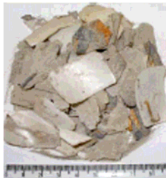
Figura 4 – LCD passado no moinho com bolas de ferro com água.
