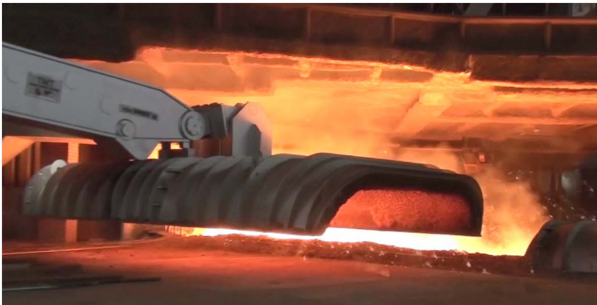
Figura 10. Tampa removida para permitir operação de tamponamento
