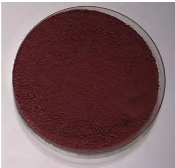
**Figura 7.** Aspecto do cobre cementado.
