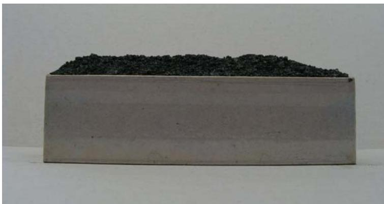
**Figura 7** – Modelo de vagão com carga de minério PXBR (teor de umidade = 11%, velocidade = 19,4 m/s; tempo = 90 min).
