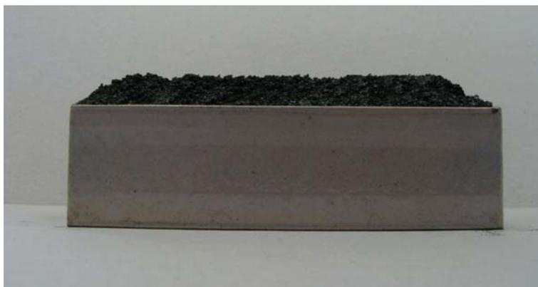
**Figura 6** – Modelo de vagão com carga de minério PXBR (teor de umidade = 11%, velocidade = 19,4 m/s; tempo = 0 min).
