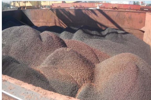
Figura 3. Situação final de carregamento de pelotas onde o fator de estiva determinado não foi atingido.
