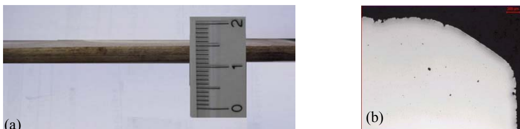
Figura 2. Vista de (a) topo a olho nu e (b) transversal via microscopia  tica da borda do aço austenítico.
