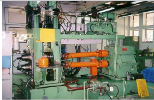
Figura 1 – Visão geral do laminador piloto do Centro de Pesquisa
