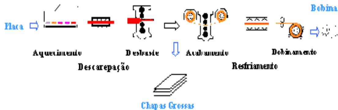
Figura 3 –Fluxograma geral do processo de LTQ da Acesita de aços inoxidáveis
