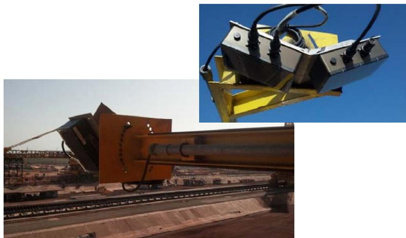
Figura 6. Radares 2D instalados nas máquinas.
