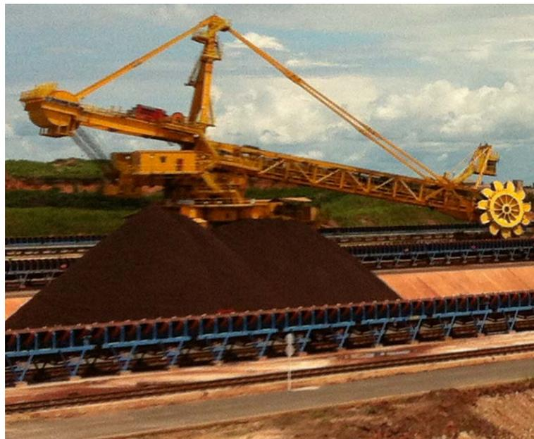
**Figura 2.** Recuperadora de roda de caçamba automatizada pelo projeto.
